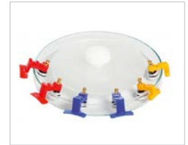
Naczynie do namaczania elektrod mostkowych w roztworze soli
